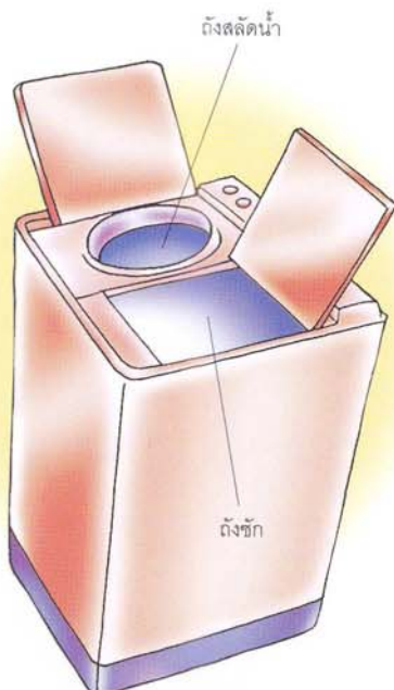
ถังสลัดน้ำและถังซักของเครื่องซักผ้าแบบกึ่งอัตโนมัติ
